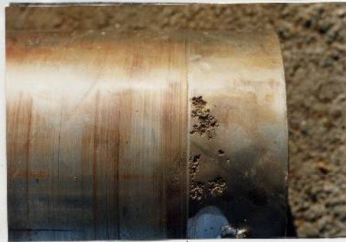
図1 常温海水中で使用したステンレス鋼製海水ポンプスリーブの摺動部分に生じた孔食損傷、
