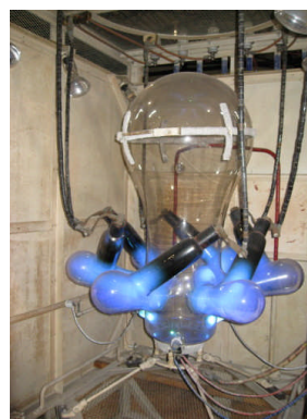
ガラス製水銀整流器
