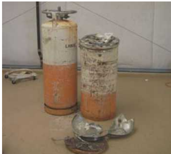
無傷のシリンダーと 破損したシリンダーの残骸
