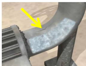
これは配管の亀裂か?
