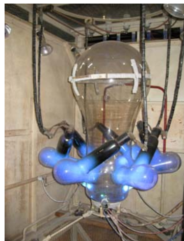
写真2 ガラス製水銀整流器 (1961年製)
