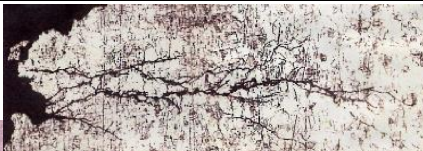
オーステナイト系ステンレス鋼(SUS316)製送風ファンのインペラの塩化物応力腐食割れ
