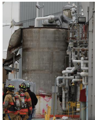
火気使用作業中に発生した致命的な火災と過剰圧力の結果。
