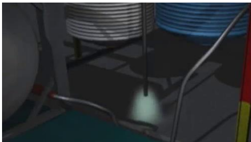
図2. プロセスエリア付近の低位置で放出されたプロセス蒸気
