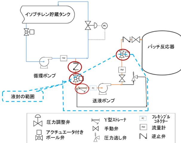
図1 大規模ガス爆発を起こした構成を示す簡略図(CSB提供)
