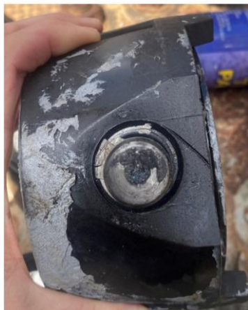
図2. 閉塞した圧力計の事故写真
